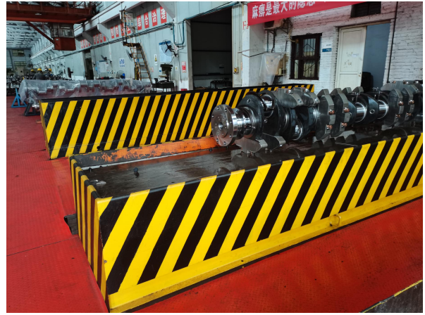
曲轴分公司加工车间曲轴清洗区
