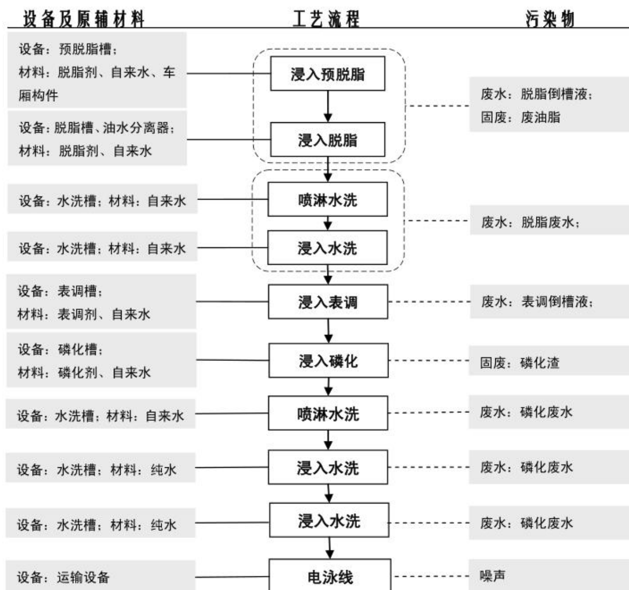
图 2.5-6 前处理工艺流程及产污位置图
