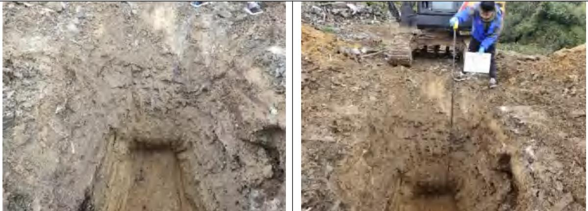
长发井区域 (填土层, 夹杂黏土和块石, 及部分泥岩)
