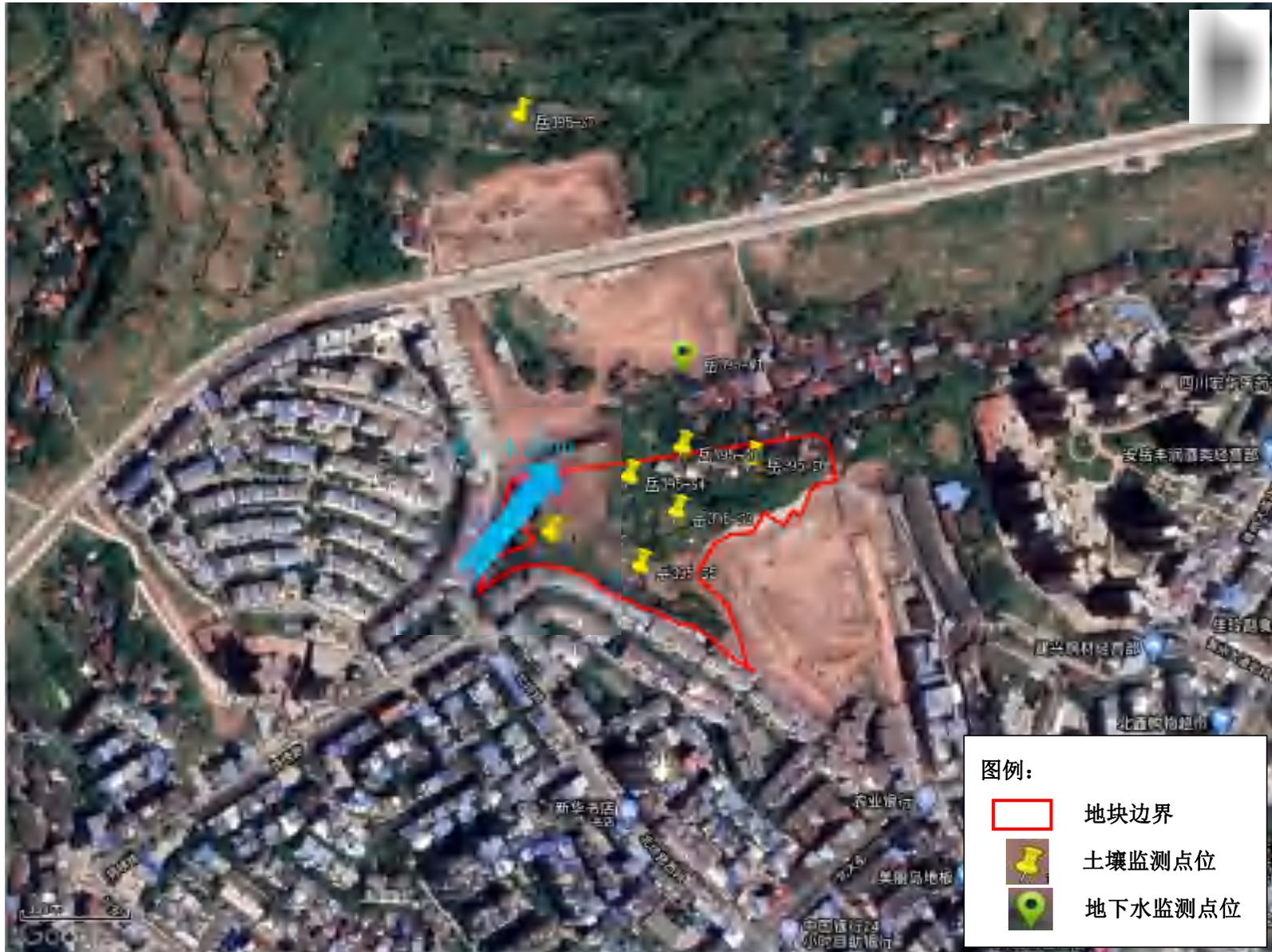
图 4.2-6 岳 395 号地块土壤及地下水采样监测布点图
