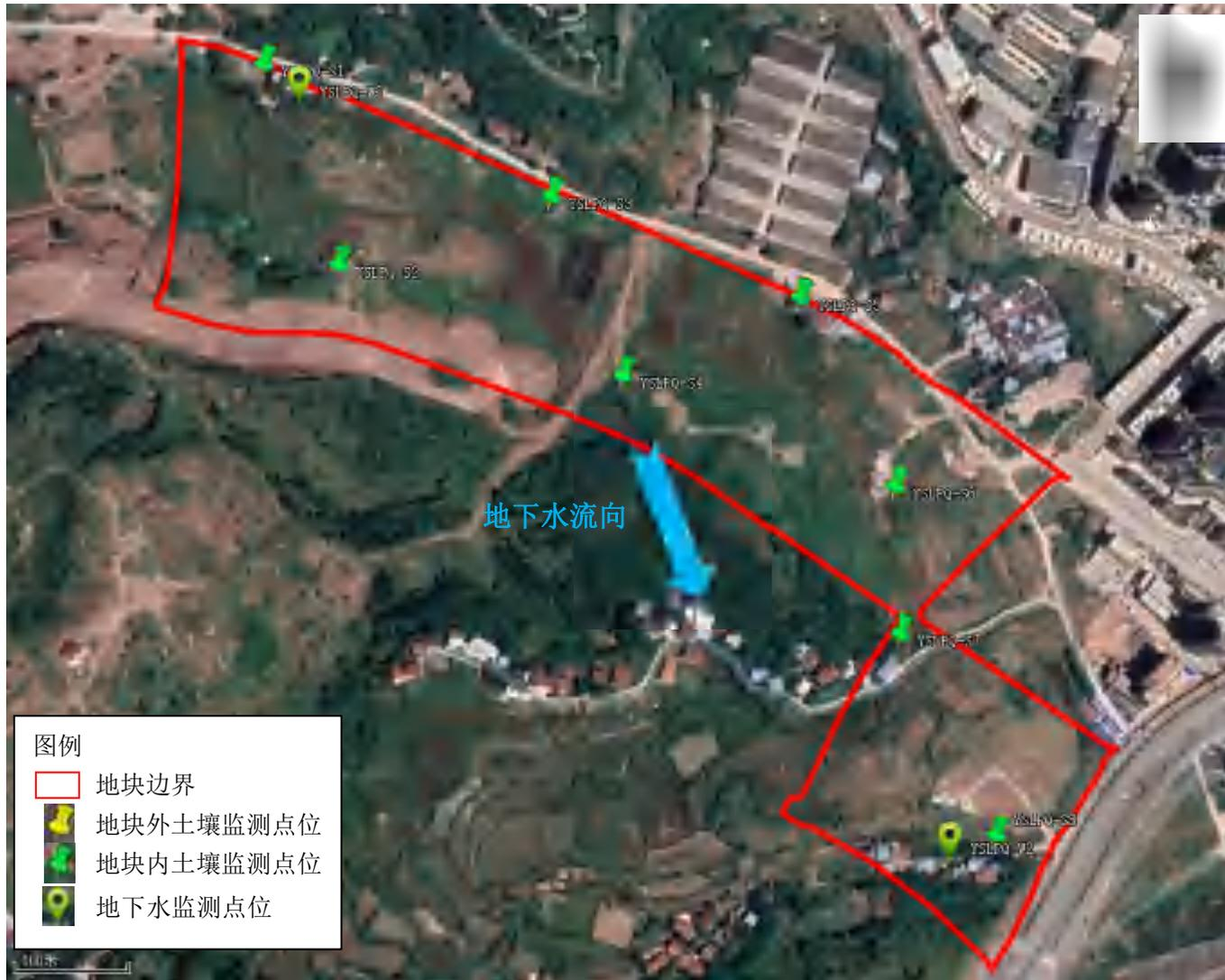
图 4.2-8 岳石路片区地块土壤和地下水采样监测布点图
