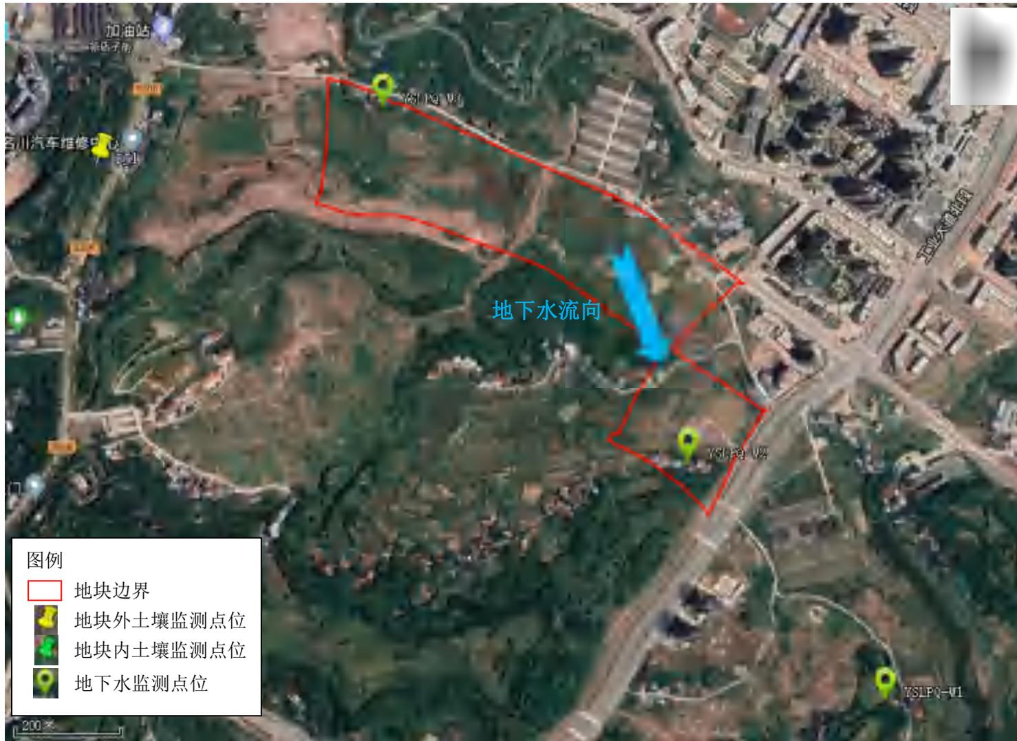
图 4.2-9 岳石路片区地块土壤对照点和地下水下游点位采样监测布点图
