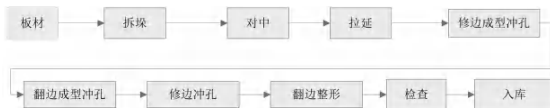
图 4.2-10 机械加工工艺流程图
