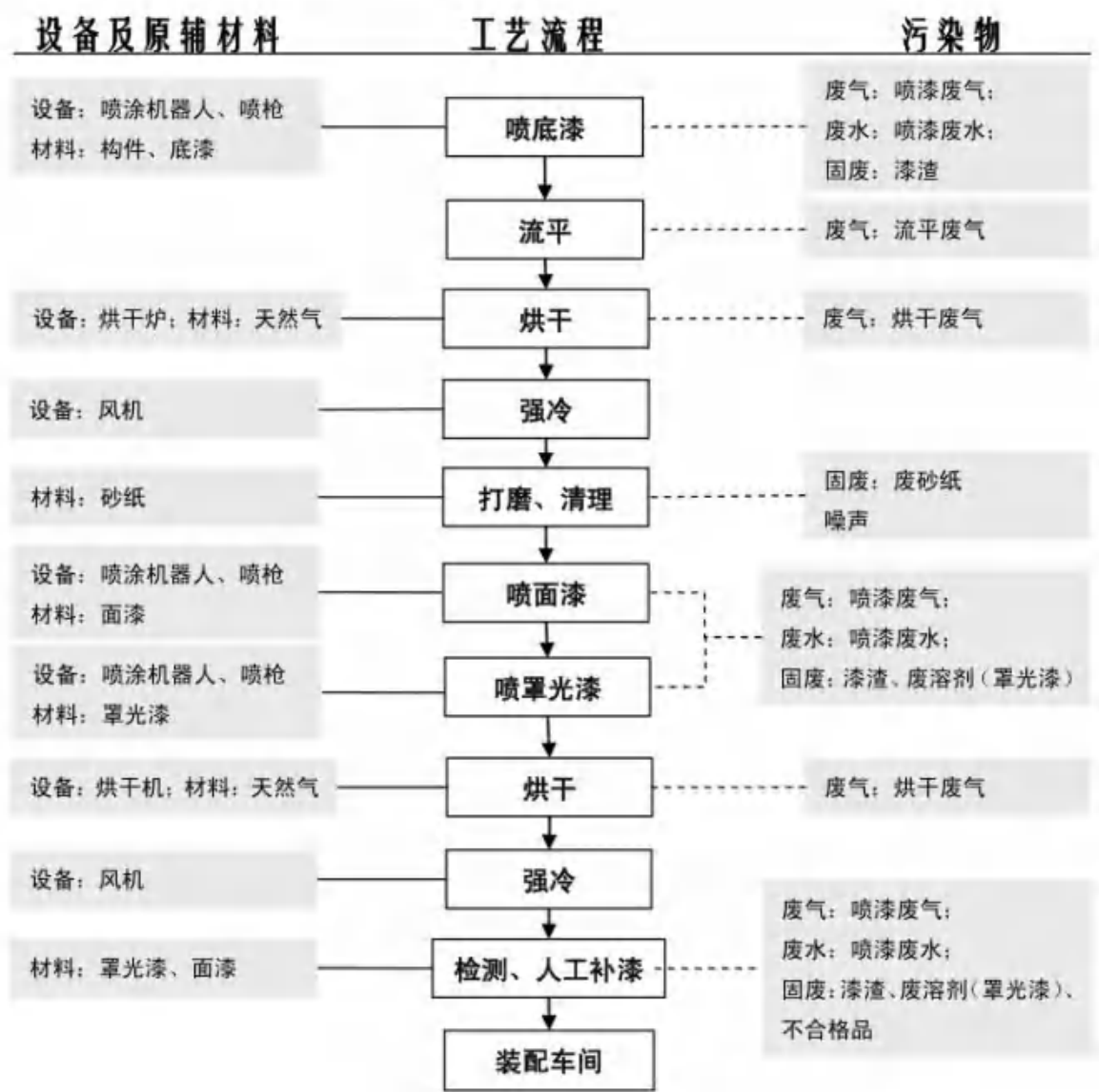
图 4.2-8 喷漆工艺流程及产污位置图
