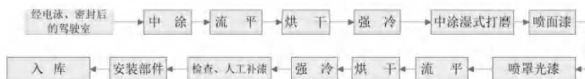
图4.2-13 电泳工艺流程简图
