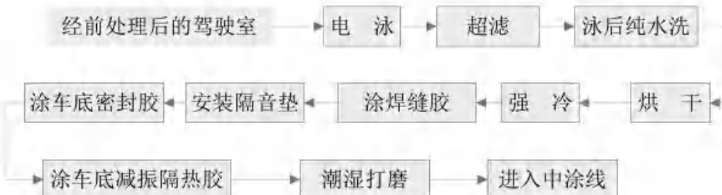
图4.2-12 前处理工艺流程简图
