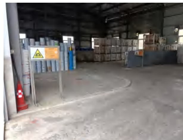
集团总部危废暂存间（液态物料区围堰）
