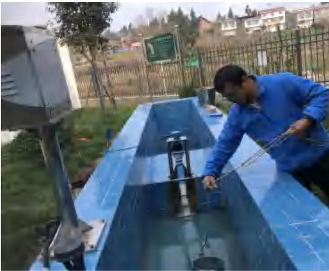
总排口废水监测照片
