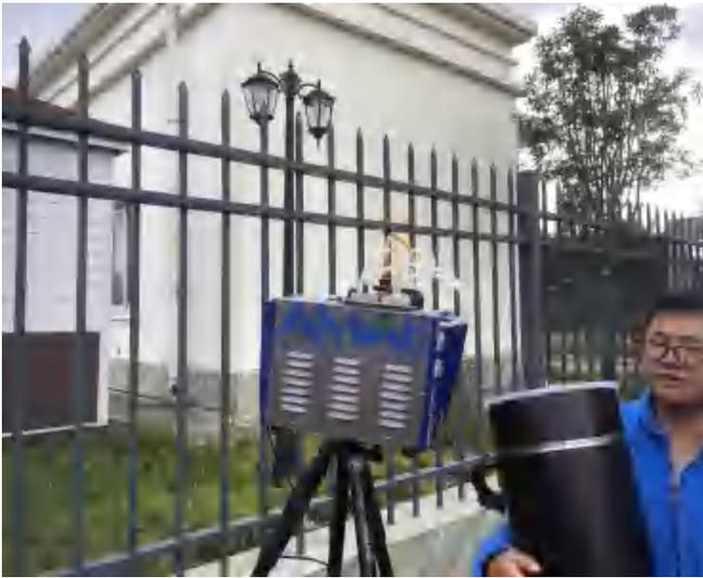
无组织废气采样监测照片
