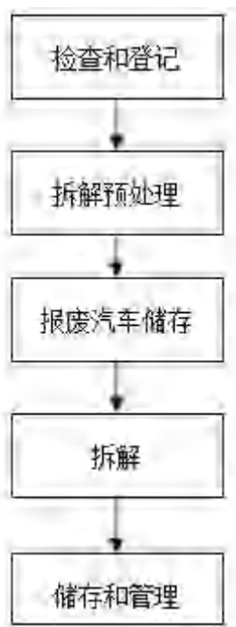
图 4.3-1 报废汽车拆解作业流程图
