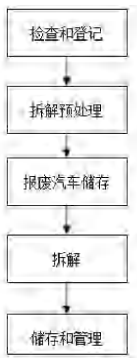
图 3-1 报废汽车拆解作业流程图
