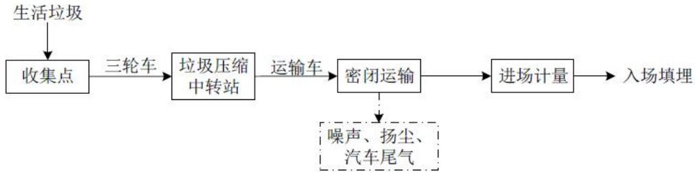
图4-2 收运工艺及产污环节流程图
