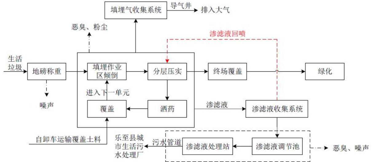
图4-3 生活垃圾填埋工艺及产污环节流程图
