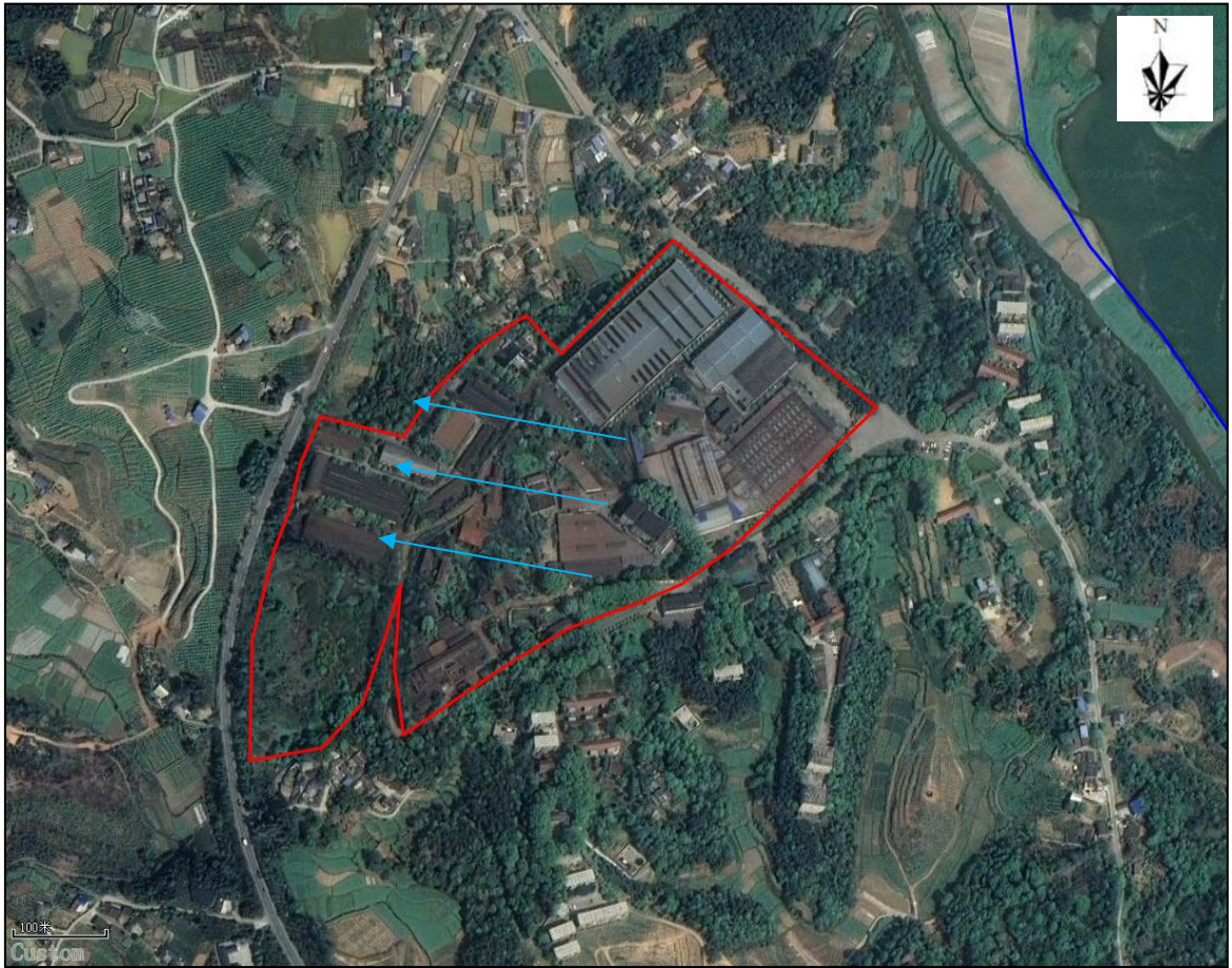
图3.3-3 地块内地下水流向图
