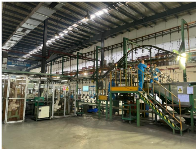
机加/装配车间内电泳线
