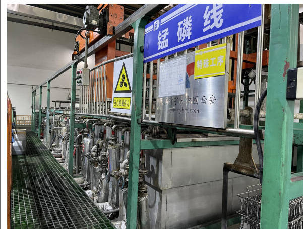
机加/装配车间内磷化线
