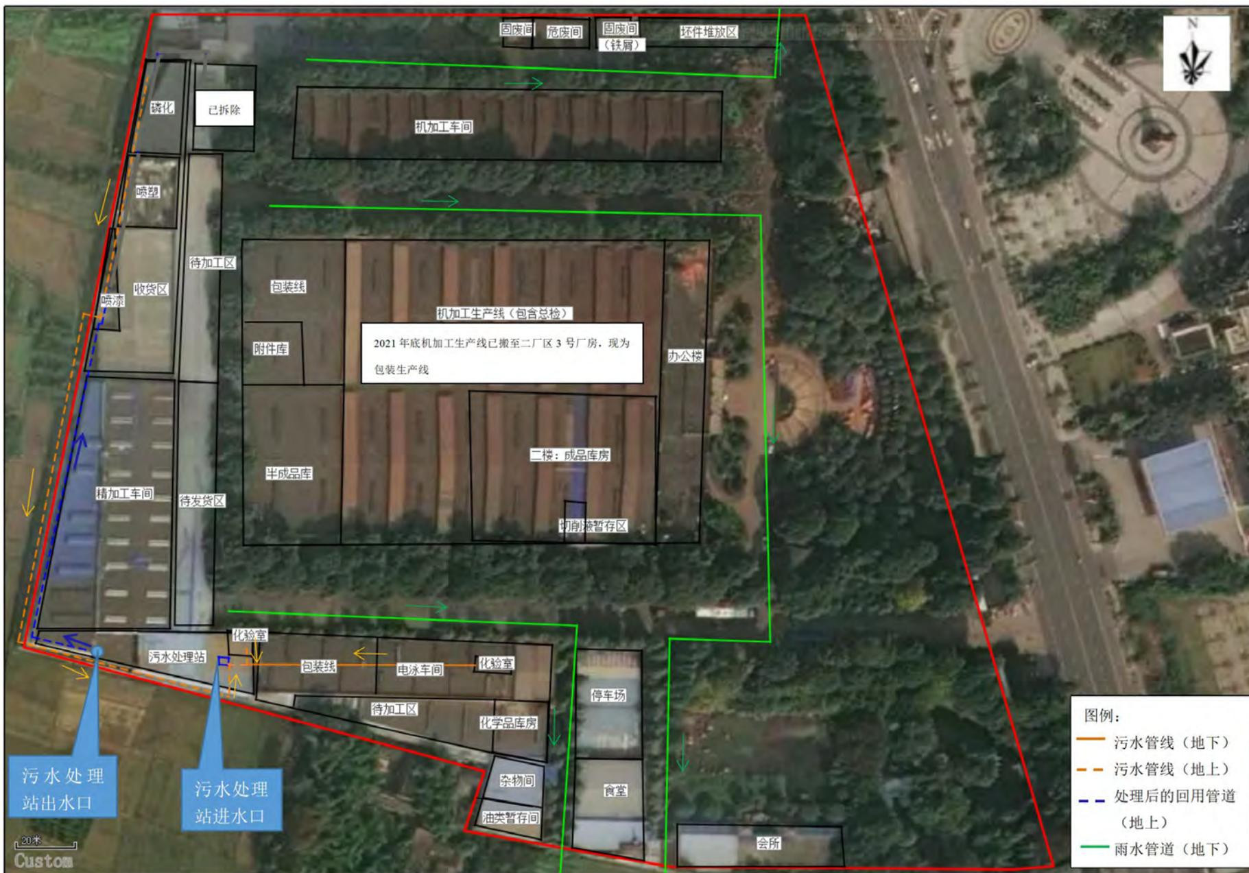
图4.7-1 一厂区内地下水污水管线和地上污水管线走向图
