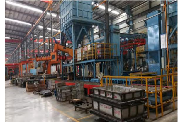
2号厂房（树脂砂铸造生产线）
