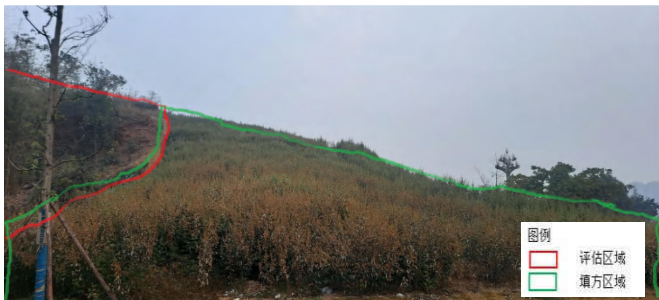
5.3.6-2 附近挖方、填方区图现场照片图
