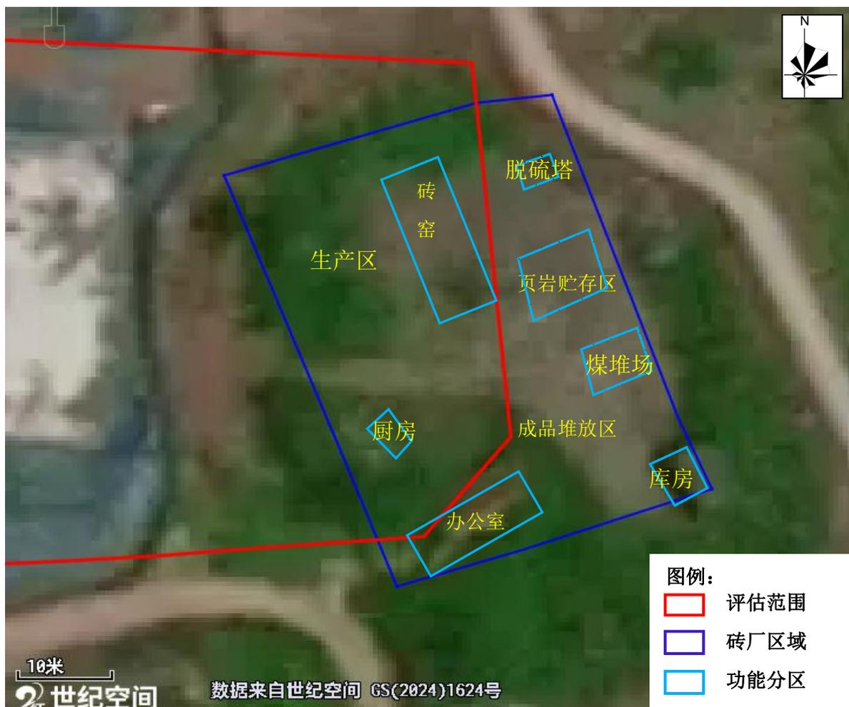
图 3.4-2 砖厂平面布局图
