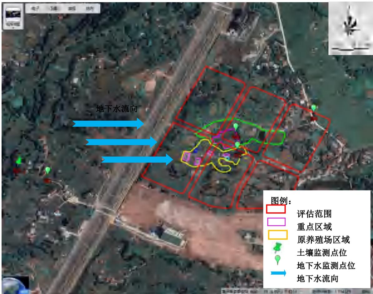
图 5.2-2 地下水监测点位和土壤对照点分布图
