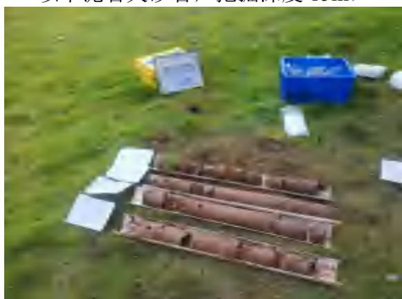
S12 (0-0.5m 回填土、0.5-4m 粉质黏土，挖掘深度 4m)
