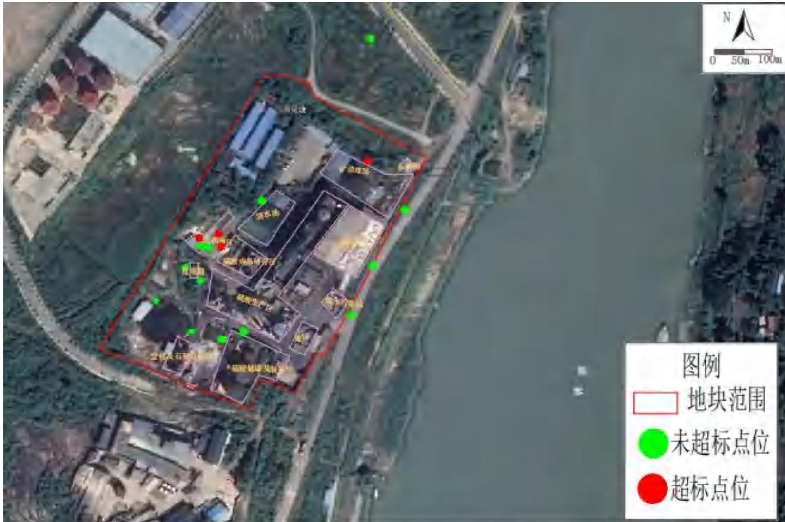
图2.3-5 自贡金星化工有限公司地块砷超标点位分布图（0.5-3m）
