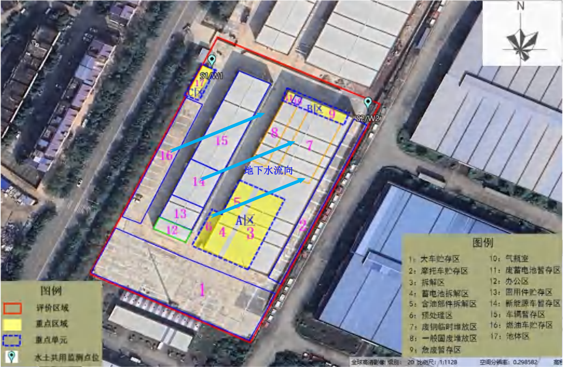
图 5.3-1 地块内土壤和地下水自行监测点位分布图
