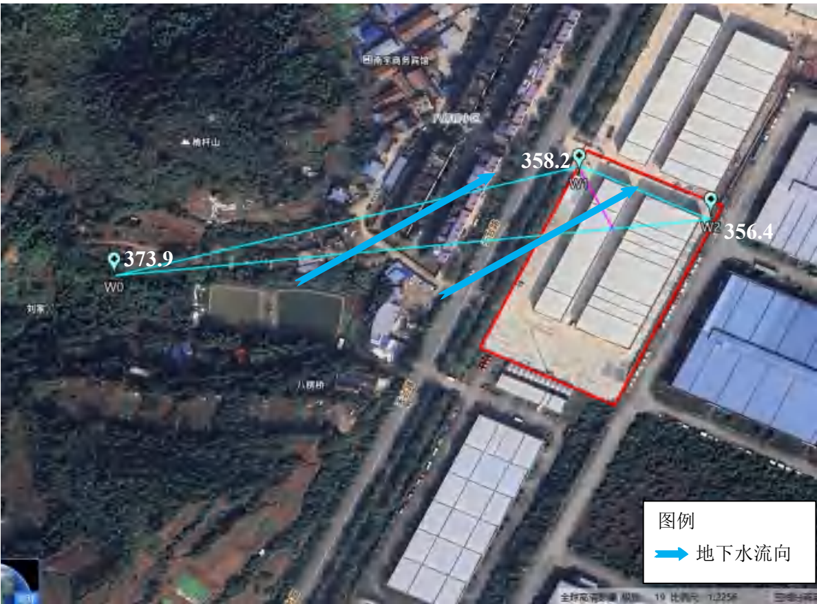
图 2.1-5 地块所在区域地下水流向图
