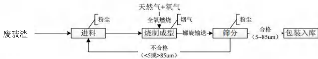
图 2-3 玻璃微珠生产工艺流程及产排污环节图
