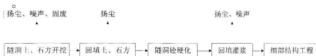
图 4-1 取水口施工工艺流程及产污位置图
