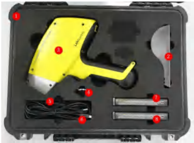
TrueX 手持式 X 射线荧光分析仪
